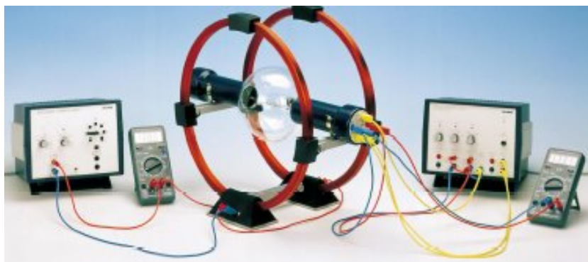
Figura 6 - Montagem do experimento para a determinação da carga elementar do elétron.
