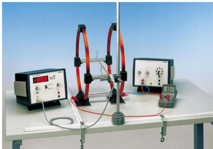
Figura 3 - Aparato experimental para o mapeamento do campo magnético de bobinas circulares.
