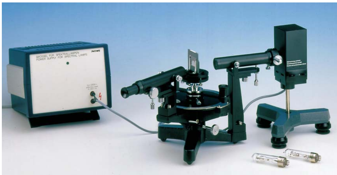
Figura 4 - Aparato experimental utilizado para medida dos espectros atômicos do hélio e do sódio.
