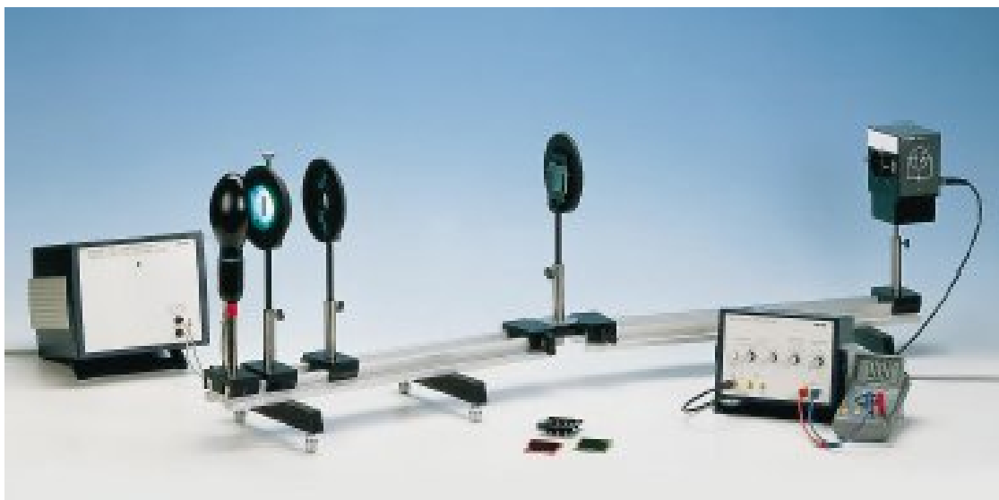
Figura 1 - Aparato para a realização do experimento efeito-fotoelétrico.
